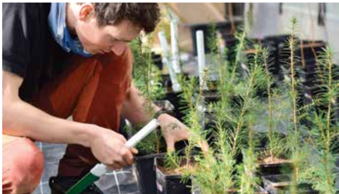
Installation von Temperatur- und Bodenfeuchtesonden in den Versuchsgefäßen. Foto: Jan Böhm / ThüringenForst
