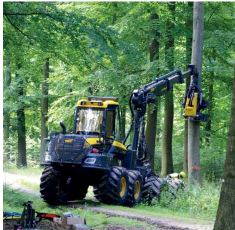
Ein Harvester unterstützte hier den Motorsägenführer bei der Fällung.
