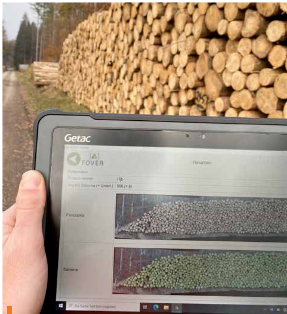
Foto-optisch: Mit FOVEA können Holzpolter schnell erfasst und Festmeter, Stückzahl und Stärkeklassenverteilung noch im Wald berechnet werden.
