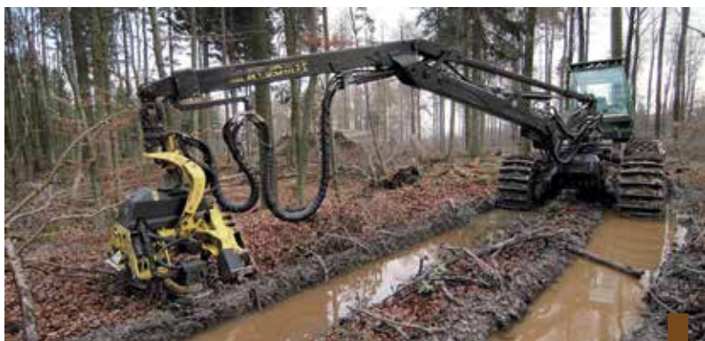
Verdichtung und Verformung des Bodens durch Einwirkung des Gesamtgewichtes. Strukturverformung und Absenkung der oberen Schichten bis zu 20 cm.
