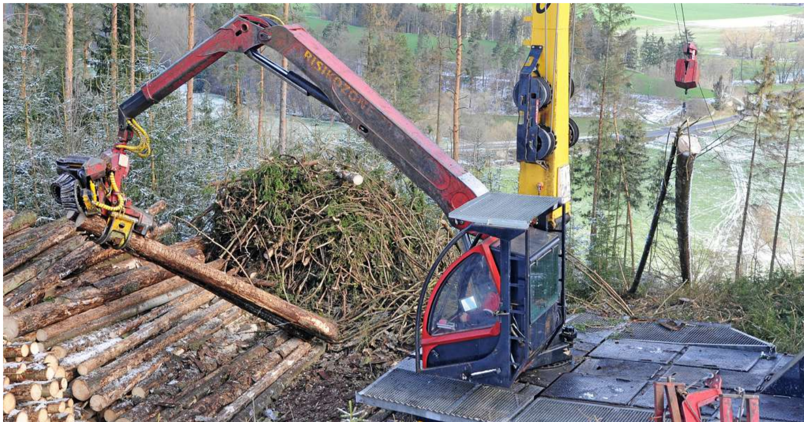
Rund 1500 Festmeter vom Borkenkäfer geschädigtes Nadelholz wird derzeit mit einem Hochgebirgsharvester MOUNTY an einem Steilhang oberhalb der Schleizleite nahe Möschlitz geerntet.
